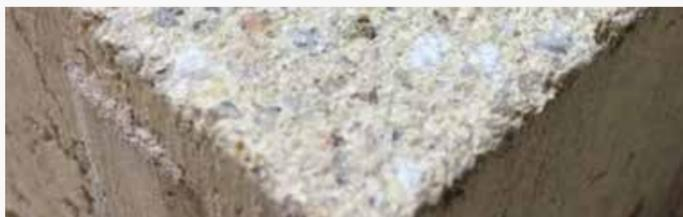
**Lavé** : Aspect décoratif qui consiste à faire apparaître les graviers par élimination de la couche superficielle obtenu en alliant une formule de béton adaptée et une technique de coulage.
