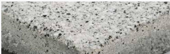
**Grenailé** : Cet aspect est obtenu en projetant des grains d'acier à l'état sec sur la surface de la pierre pour obtenir une rugosité. Cette technique permet d'uniformiser la teinte de la pierre.
