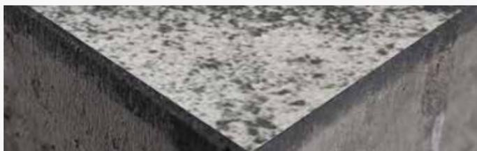
**Flammé** : Une finition légèrement structurée à l'aspect écaillé. Ce résultat est obtenu par un écaillage superficiel résultant du passage de la pierre sous une flamme appliquée sur la face supérieure.
